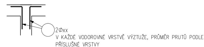
PŮDORYSNÉ SCHÉMA ZAKONČENÍ VODOROVNÉ VÝZTUŽE 1:50
